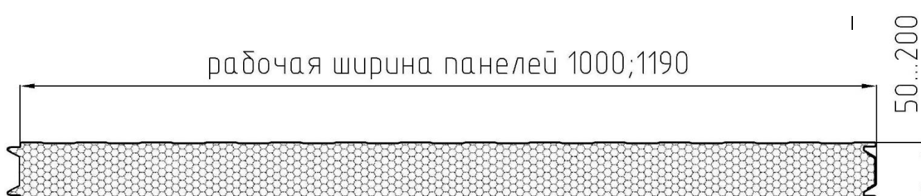
Рисунок 15. Геометрия стеновой сэндвич-панели с замковым соединением Z-Lock (ПСТ Z)
