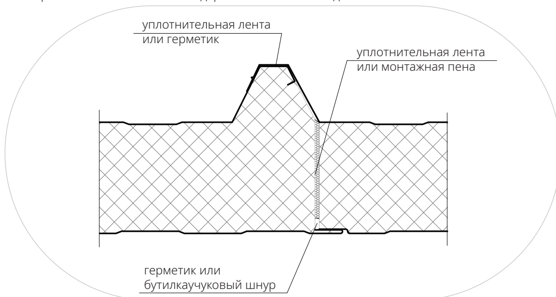
Рисунок 22. Стык кровельных панелей со стандартным замковым соединением
