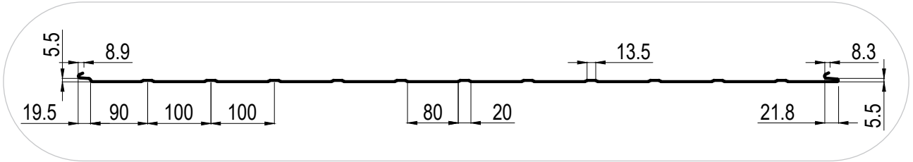
Рисунок 18. Виды профилировки внешней стороны сэндвич-панелей ПСТ Z
