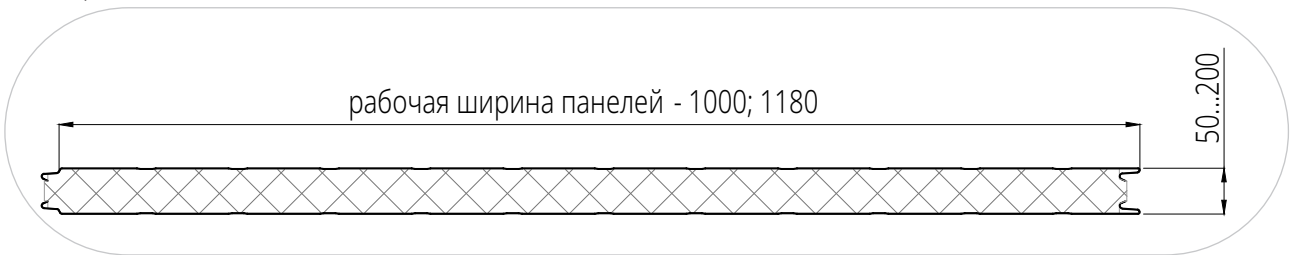
Рисунок 16. Стык стеновых панелей с замковым соединением Z-Lock
