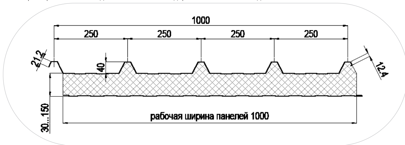
Рисунок 21. Геометрия кровельной сэндвич-панели со стандартным замковым соединением
