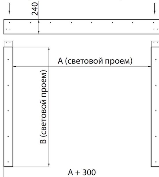
Рисунок 4. Металлическая накладная рама для дверей ОД F серии FERMATIC 3500. Вариант без порога
