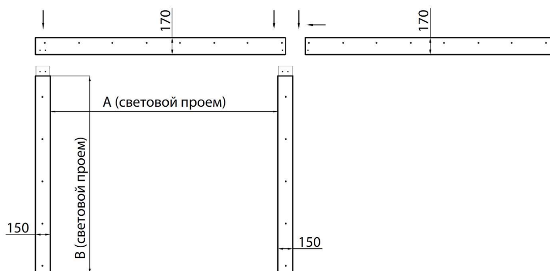
Рисунок 3. Металлическая накладная рама для дверей ОД F серии FERMATIC 2157. Вариант без порога
