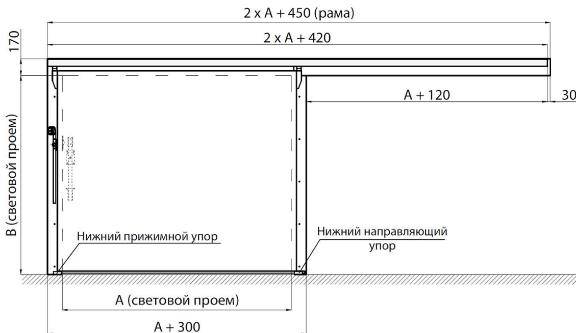
Рисунок 5. ОД F 2157 с накладной металлической рамой. Вариант без порога
