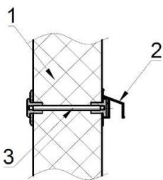
Рисунок 7. Крепление нижней направляющей к стене из сэндвич-панелей.
