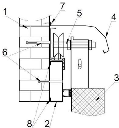
Рисунок 8. Крепление верхней направляющей и защитного кожуха к кирпичной стене.
