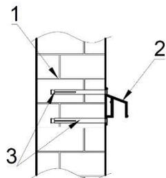
Рисунок 10. Крепление нижней направляющей двери к кирпичной стене.
