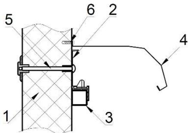
Рисунок 6. Крепление верхней направляющей и защитного кожуха к стене из сэндвич-панелей.
