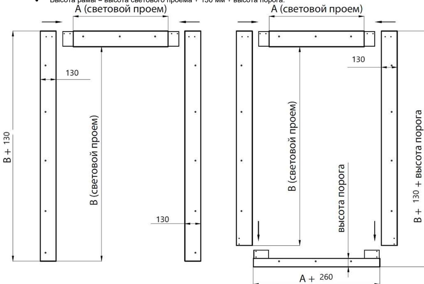
Рисунок 2. Металлическая накладная рама для дверей ОД-Т «легкой» и «тяжелой» серии. Слева – без порога, справа – с порогом
