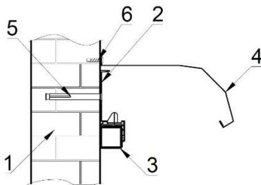
Рисунок 9. Крепление верхней направляющей и защитного кожуха к кирпичной стене.
