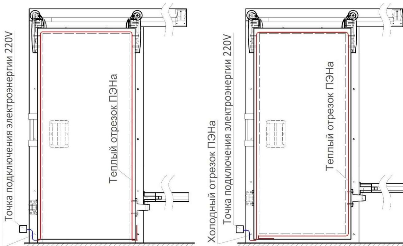
Рисунок 11: Схема расположения провода ПЭН в накладной раме
