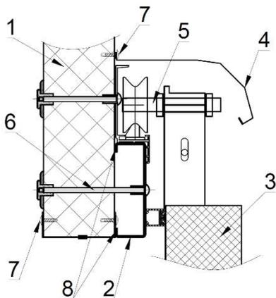
Рисунок 5. Крепление верхней направляющей и защитного кожуха к стене из сэндвич-панелей. Сечение в участке проема.
