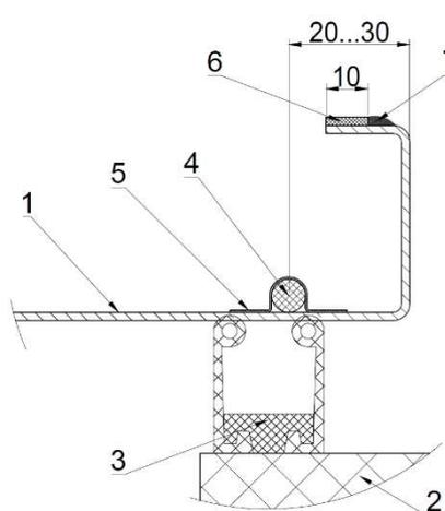
Рисунок 12. Узел крепления ПЭНа на раме
