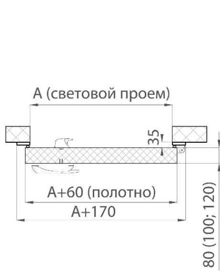
Рисунок 3. РДО с накладной металлической рамой Слева – без порога, справа – с порогом
