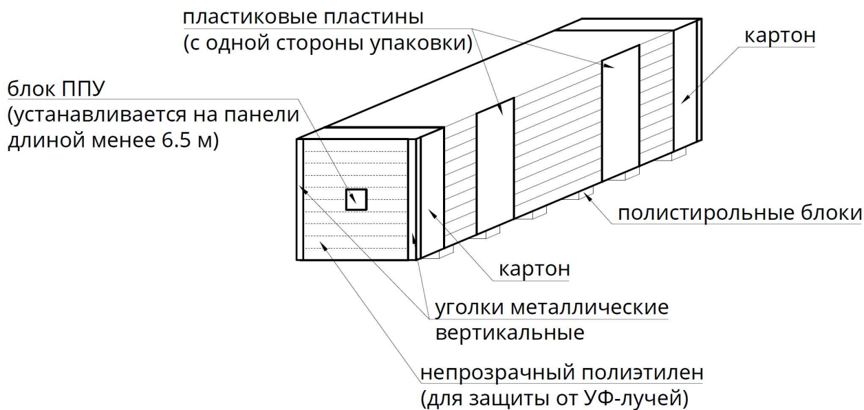
Рисунок 4. Легкая транспортная упаковка стеновых панелей непрерывной линии
